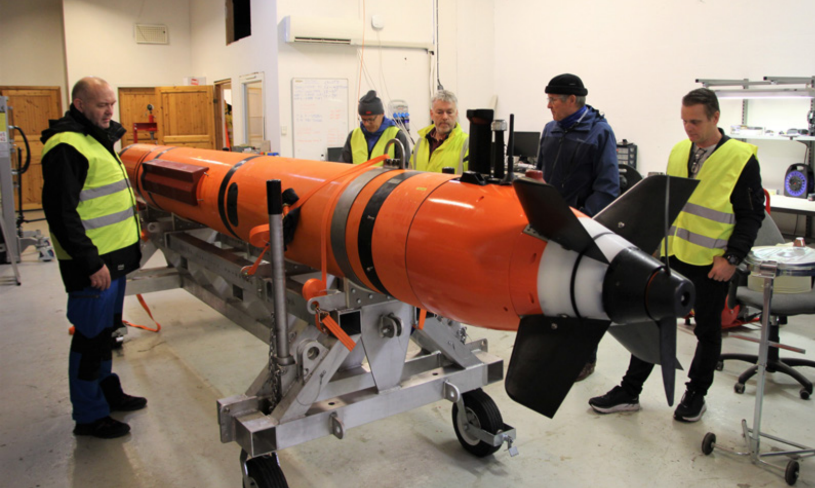
Det var en milepæl for Havforskningsinstituttet da den første av to autonome undervannsfarkoster (Autonomous Underwater Vehicle, (AUV)) ankom Bergen i oktober 2021. Disse dronene vil bidra til å effektivisere datainnhenting ved å «fly» over havbunnen og samle inn forskningsdata etter de ruter som programmeres inn på forhånd. Foto: Anders Jakobsen/HI
