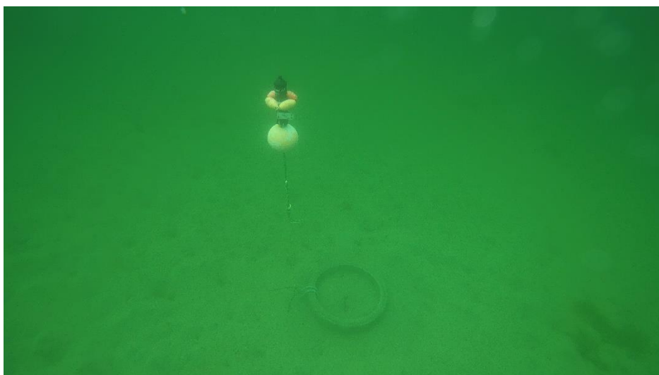
Figur 7. Nedsenket lyttestasjon for akustisk telemetri.
