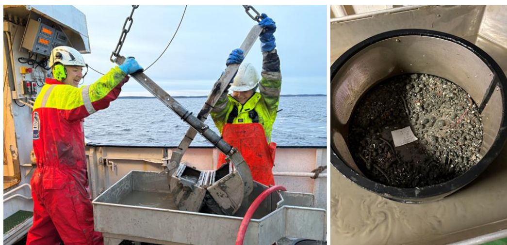
Figur 5. Gjennomføring av prøvetakning med sedimentgrabb om bord på G.M. Dannevig høsten 2025. Foto: Norconsult
