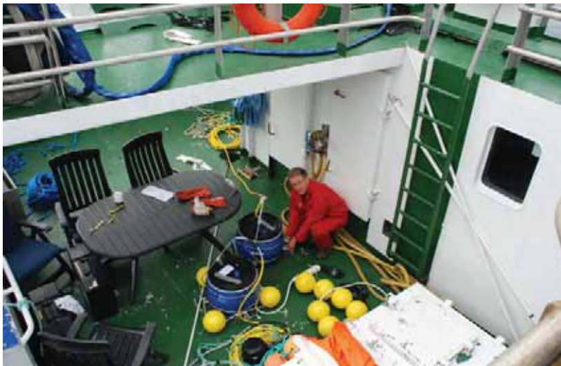
Figur 7. Rigging og klargjøring av instrumentbeholdere med styreenheter for kamera pan og tilt, samt utstyr for trådløs sending av videoopptak for mottak ombord på F/F ”Fangst”.
