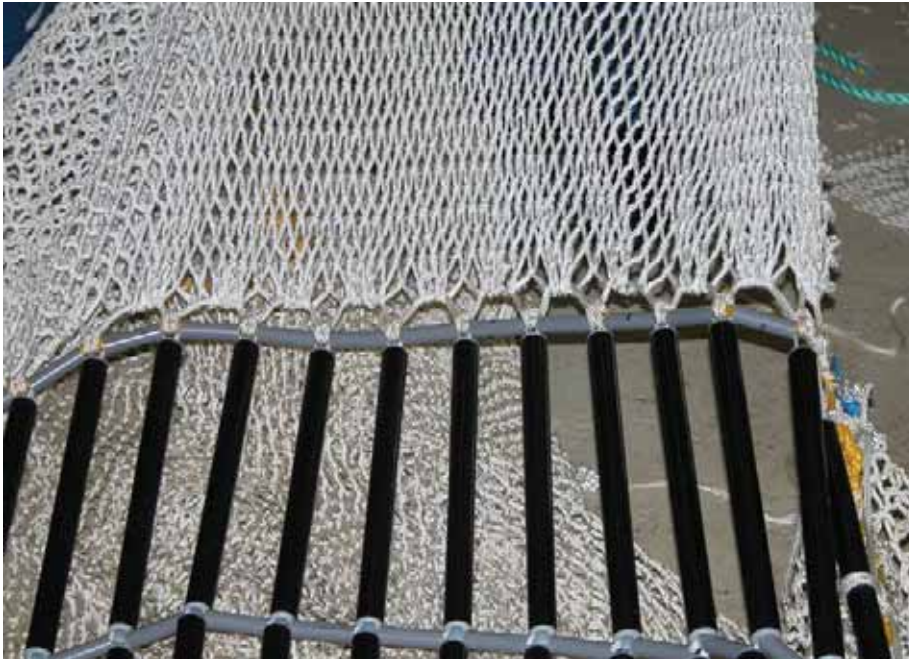
Figur 3. Flexipanel med 40 mm spileavstand, sydd fast mot øvre panel i led kanal som fører mot fiskeutslipp bak sorteringssystemet (se figur 7).
