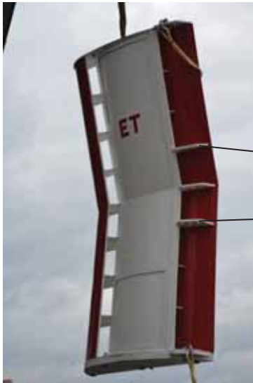
Figur 4. Alternativ rigging av haneføtter.
