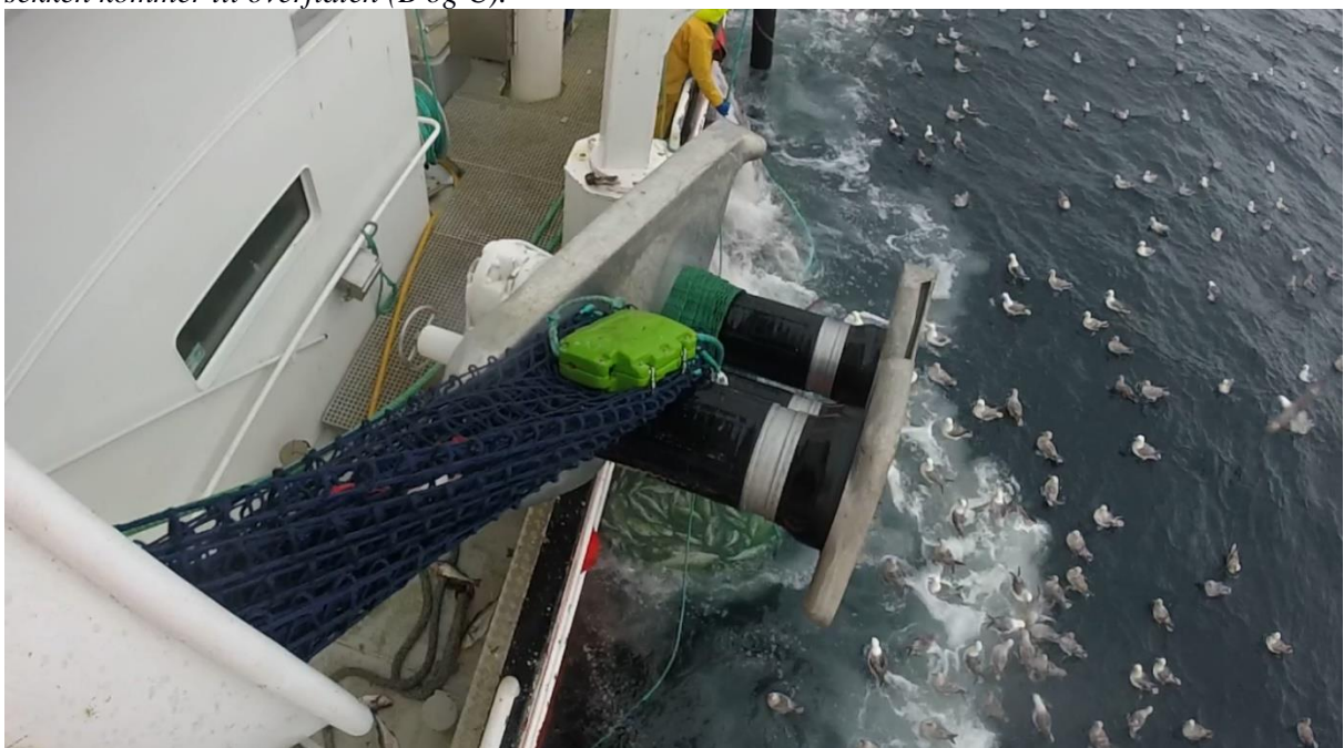
Figur 6: Sekkeutløseren er robust og går lett i gjennom triplex.
