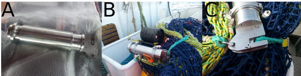
Figur 1: Sekkeutløser, første prototype. Bilde A viser selve sekkeutløseren, B viser utløseren montert på en snurrevadsekk med kamera for å filme utløsning (svart rør) og en dybdesensor som registrerer dyp hvert sekund. Bilde C viser hvordan utløseren brukes for å strupe sekken med et tau som sjakles i utløseren, dras rundt sekken og festes til utløserkroken.
