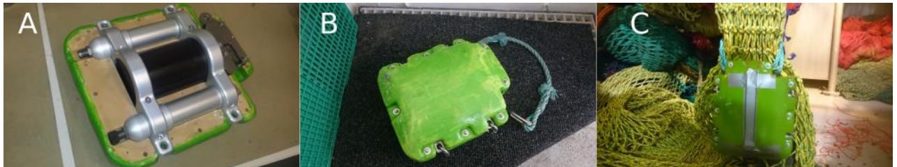
Figur 2: Tegning av sekkeutløser, prototype II. Bildet til venstre (A) viser utløseren når beskyttelseskappen er fjernet. I midten (B) ser vi utløseren klar for å festes på snurrevadsekken, og lengst til høyre (C) ser vi utløseren på snurrevadsekken.
