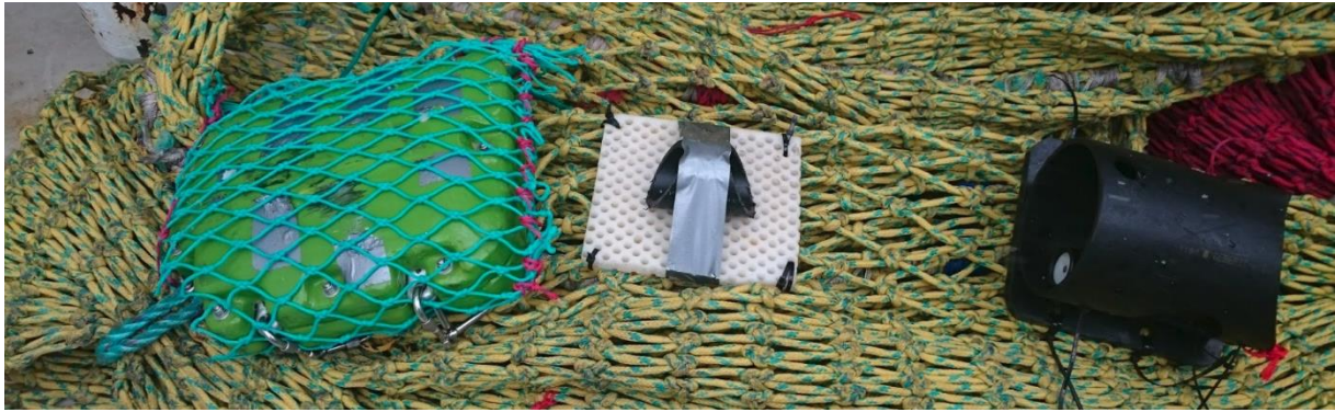
Figur 4: Sekkeutløser med dykkecomputer som viser dyp (hvit plate midt på bildet og kamera for å filme utløsning og dokumentere dyp.
