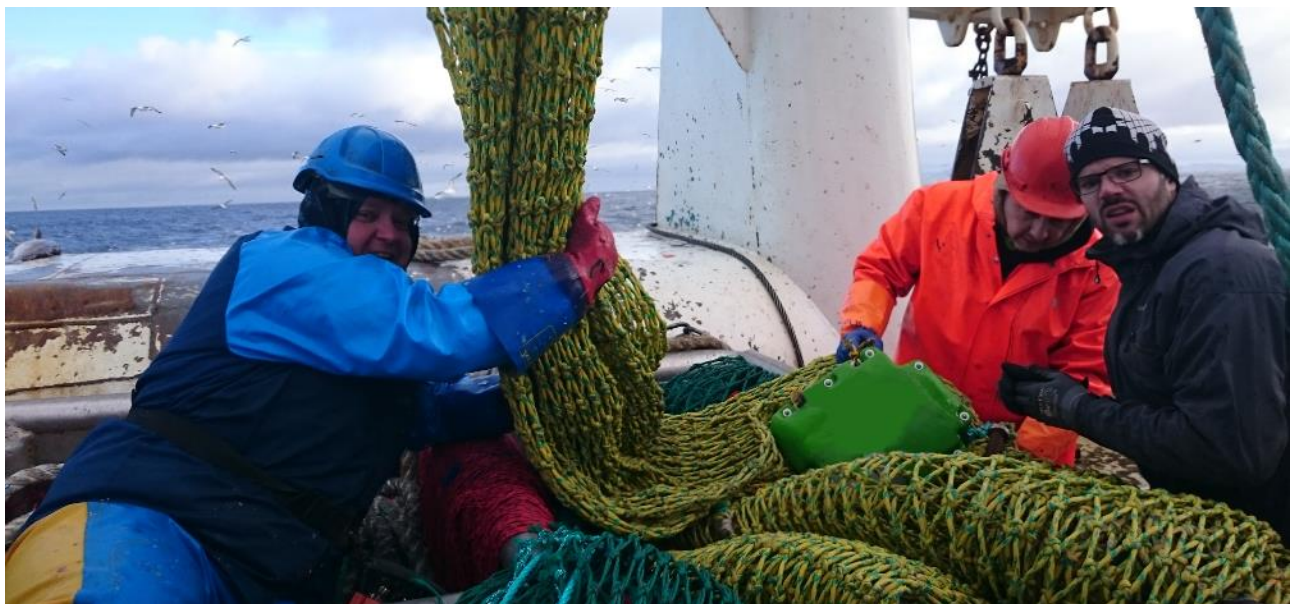
Figur 3: Sekkeutløser, prototype II montert på sekken, klargjøres før snurrevaden settes.
