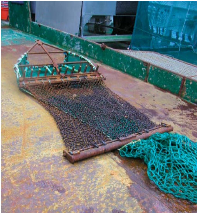
Figur 7b. Foto av Muslingskrape fra underside med ringbrynje. Standard oppsett bruker 10 mm vaier med en lengde som er 3 ganger bunndyp pluss 50 m. Slepefarten er 2 knop og tauetiden er 10 minutter fra stopp slakk til start hiv.
