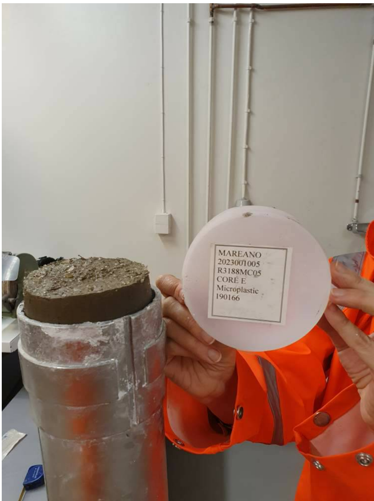
Figur 3: Utskyvning av sedimentprøve fra stålrør.
