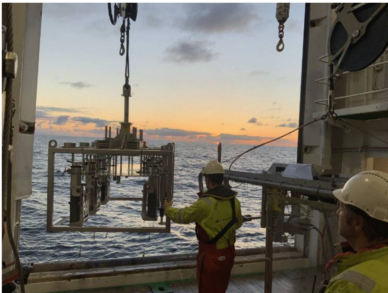
Figur 1 : Multicorer på vei inn etter prøvetaking på tokt mai – juni 2021, stasjon R2669 fra ytre Vestfjorden. Kilde: Metodedokument-Kjemiprogram-2023, NGU/Mareano.
