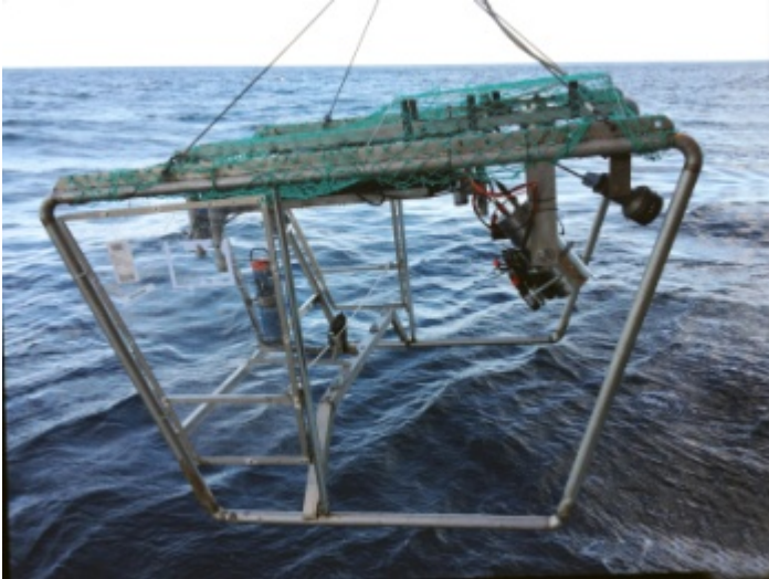
Figur 1: Videoriggen «Chimaera» som er utstyrt med flere videokamera, laserpunkter for størrelsesmåling, transponder for posisjonering og CTD.
