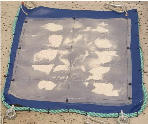
Figur 4. Plastmatter med brent kalk for behandling av havnespy på vertikale vegger.
