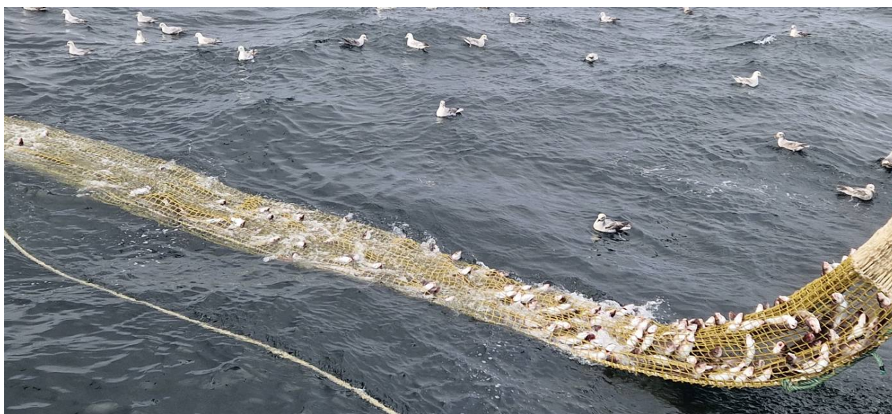
Figur 14 . Bildet er tatt i havoverflaten fra fartøyet og viser betydelige mengder med hyse som står fast i kvadratmaskene etter rømningsforsøk.
