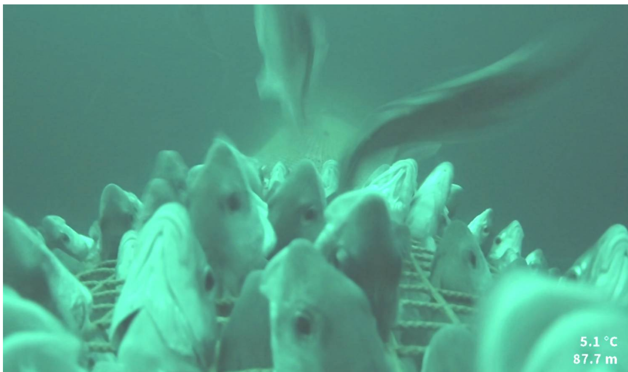
Figur 11 . Fra hal nr. 17. Etter å ha utvidet kvadratmaskeforlengelsen fra 3 til 5,25 m ble det ikke observert noen proppdannelse i seksjonen foran kvadratmaskeforlengelsen. Kledning av fisk i maskene var derimot betydelig.
