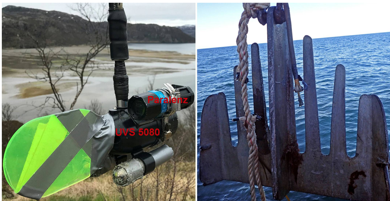
Figur 2. Undervannskamerasystem (til venstre) og ca 60 cm bred tareskrape i stål (til høyre) som benyttes til tareundersøkelser. Figur 2. Undervannskamerasystem (til venstre) og ca 60 cm bred tareskrape i stål (til høyre) som benyttes til tareundersøkelser.
