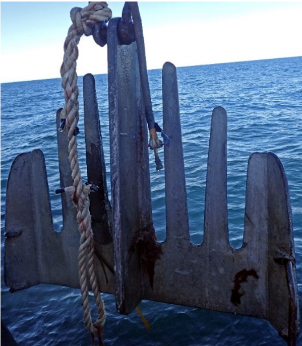
Figur 6. Tareskraper i stål (ca 60 cm bred), benyttet til innsamling av stortareplanter i Nordland
