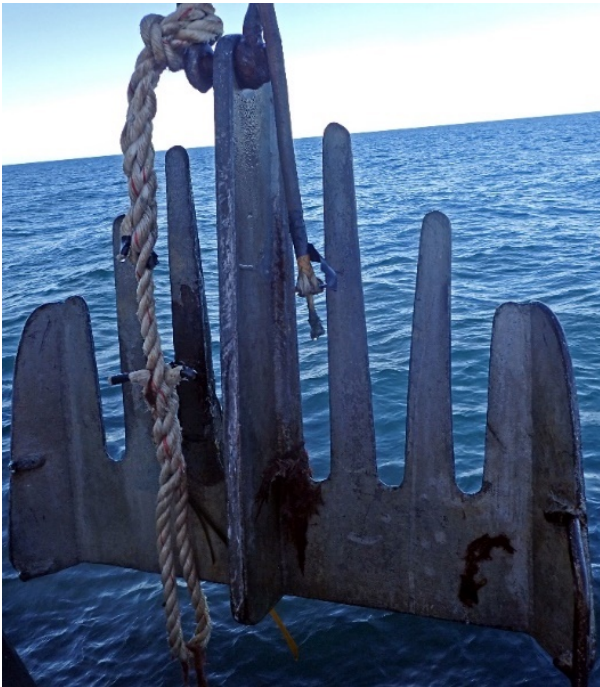
Figur 6. Tareskrape i stål (ca 60 cm bred), benyttet til innsamling av stortareplanter i Nordland
