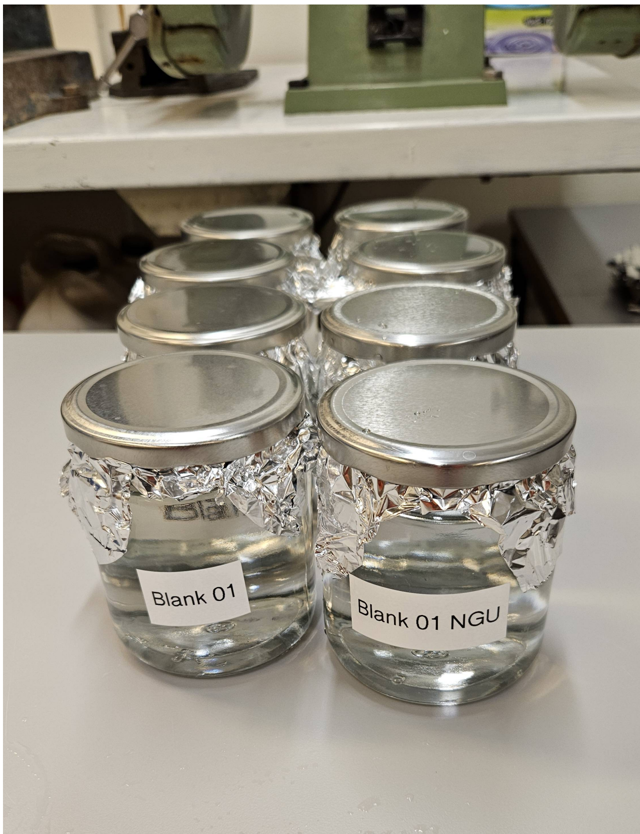
Figur 6: Glass med blankprøver (luftblank) tatt ved NGU under uttak av prøvene. Bildet viser at det er tatt to paralleller, den ene sendes til HI og den andre beholdes på NGU som referanse.
