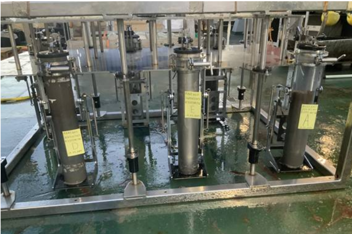
Figur 1 : Multicorer etter vellykket prøvetaking om bord FF Kronprins Haakon i mars 2024 (tokt 2024007003). Kilde: NGU/Mareano.
