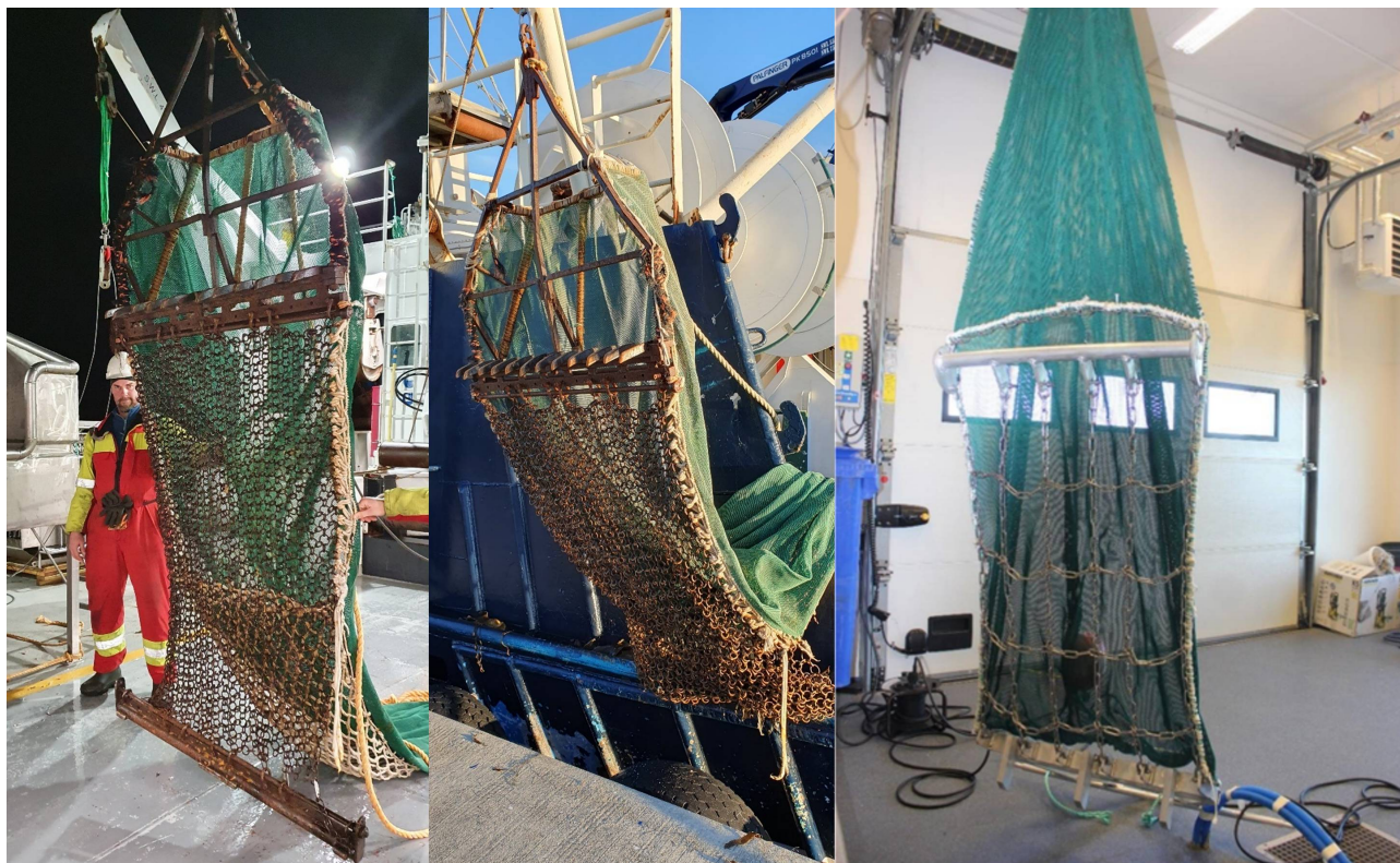
Figur 4. Bilder av tobisskrapene som ble benyttet under toktene. Bildet til venstre og i midten: standardskrapa som ble brukt på toktene i 2023 og 2024. Bilde til høyre: RF sin skrape som ble benyttet på to stasjoner på et område ved Runde i 2023 for å sammenligne med standardskrapa. Det er denne skrapa som RF bruker i sin regionale overvåkning av utviklingen i sil-populasjonene på Sunnmøre. Skrapa er laget i mindre format basert på standardskrapa slik at den kan brukes fra mindre kystbåter.
