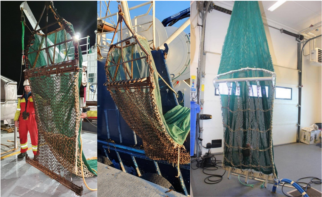
Figur 4. Bilder av tobisskrapene som ble benyttet under toktene. Bildet til venstre og i midten: standardskrapa som ble brukt på toktene i 2023 og 2024. Bilde til høyre: RF sin skrape som ble benyttet på to stasjoner på et område ved Runde i 2023 for å sammenligne med standardskrapa. Det er denne skrapa som RF bruker i sin regionale overvåkning av utviklingen i sil-populasjonene på Sunnmøre. Skrapa er laget i mindre format basert på standardskrape slik at den kan brukes fra mindre kystbåter.
