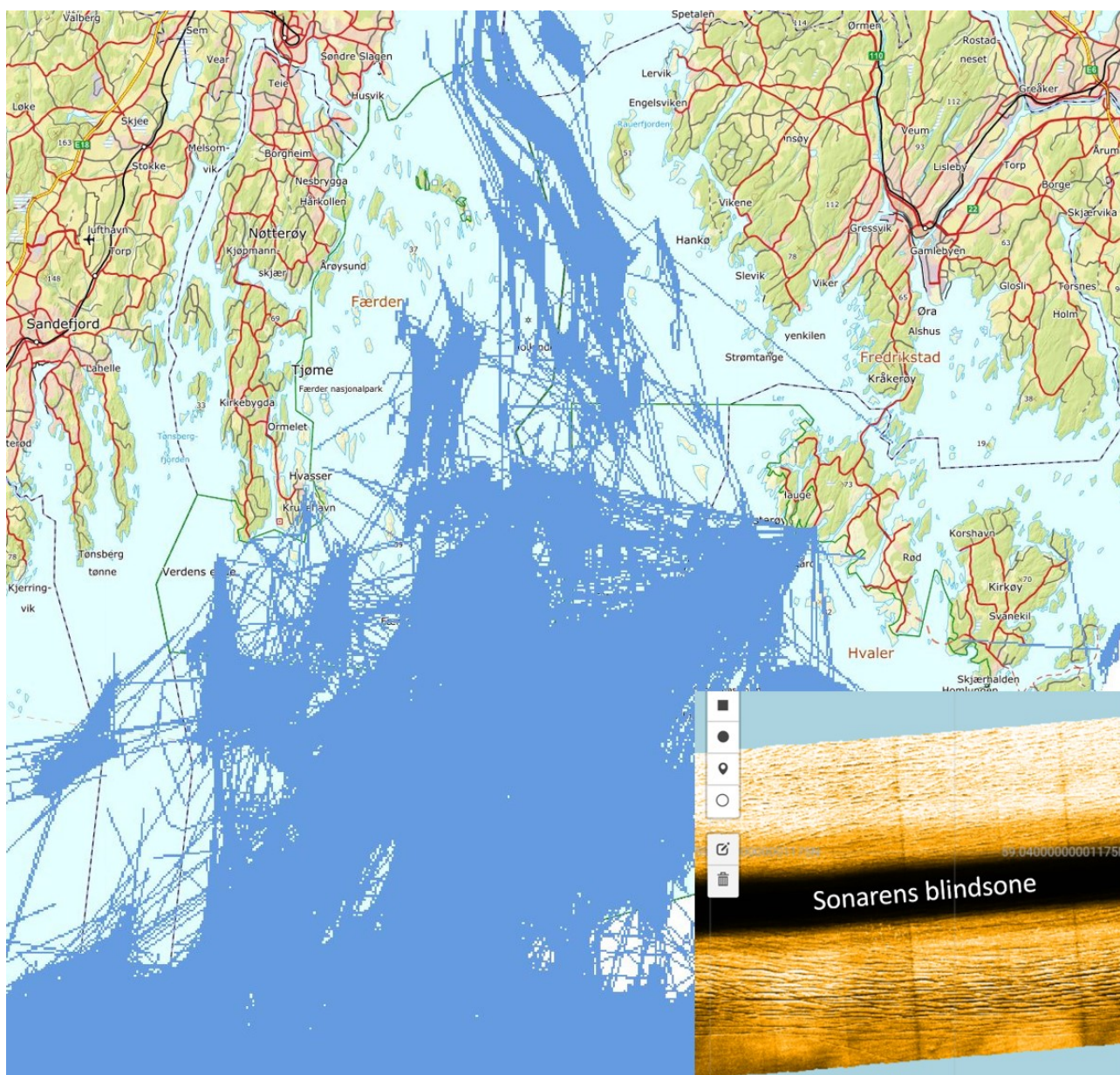
Figur 3.2.2 VMS-data («slepestrek») for fartøy som fisker med bunntål (fartøy over 15 m lengde) i ytre Oslofjord i perioden 2011–2019 (kilde: Fiskeridirektoratet). Nede til høyre: sonarbilde av trålskor på havbunnen i ytre Oslofjord tatt med Kongsberg maritimes autonome undervannsfarkost Hugin under tokt i regi av søsterprosjektet «Frisk Oslofjord» (kilde: Kongsberg maritime). «Glatting» av VMS-data vil være nødvendig for å benytte disse til vurderinger av grad av belastning fra denne flåtegruppen i perioden.
