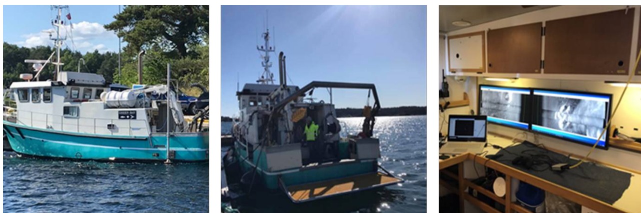
Bilde: Tyra er rigget med hekk-plattform og kombinert laboratorium/operasjonsrom.
