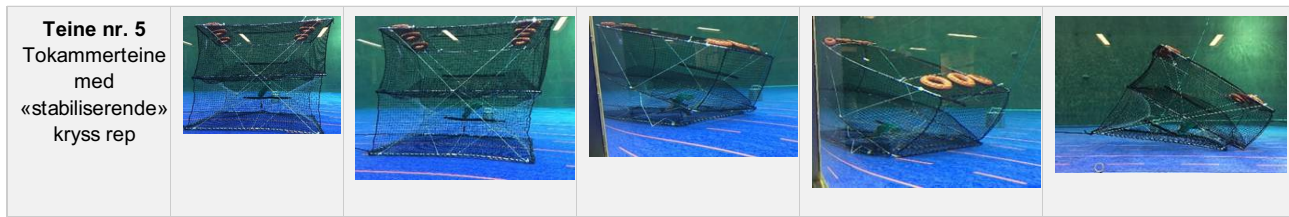
Figur 4. Bilder og beskrivelse av de 5 ulike riggingene av tokammerteinen som ble testet ut i strømtanken under økende strømforhold fra 0 til 1 knop.
