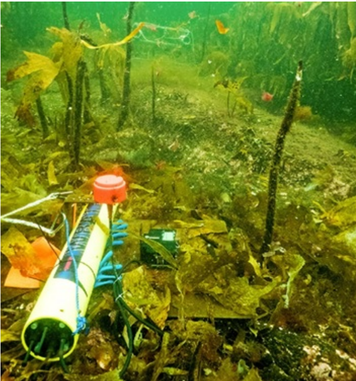
Bilde 6: Et bunnstående ekkolodd SIMRAD WBAT med 200 khz svinger som pinger oppover.
