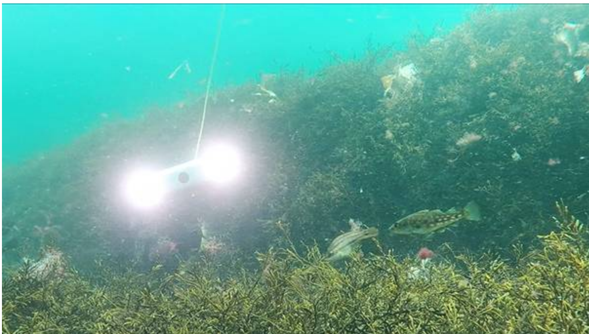
Bilde 5: En undervannsdroner som beveger seg over bunnen. Ledning opp bak er tilknyttet følgebåten. Bildet er tatt fra en RUV.
