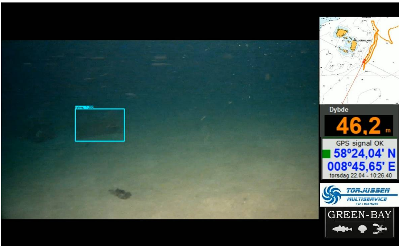
Figur 15: Deteksjon av teine med maskinsyn på video fra slepekamera.
