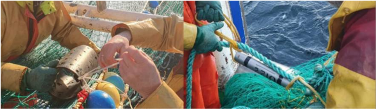
Figur 2. Kameraramme (venstre) og dybdesensor som festes i bruket.
