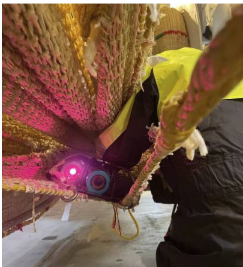
Bilde 11. Kamera montert inni fangstbegrensningsseksjonen, fremst på de store maskene i bunnpanelet.
