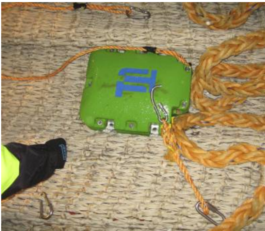
Bilde 15. Mekanisk utløser. Karabinkrok rettet opp etter første hal.
