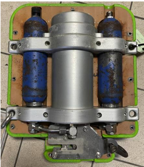
Bilde 5. Dekselet på den mekaniske utløseren måtte fjernes for å få inn sjakket (nederst til høyre på bildet).
