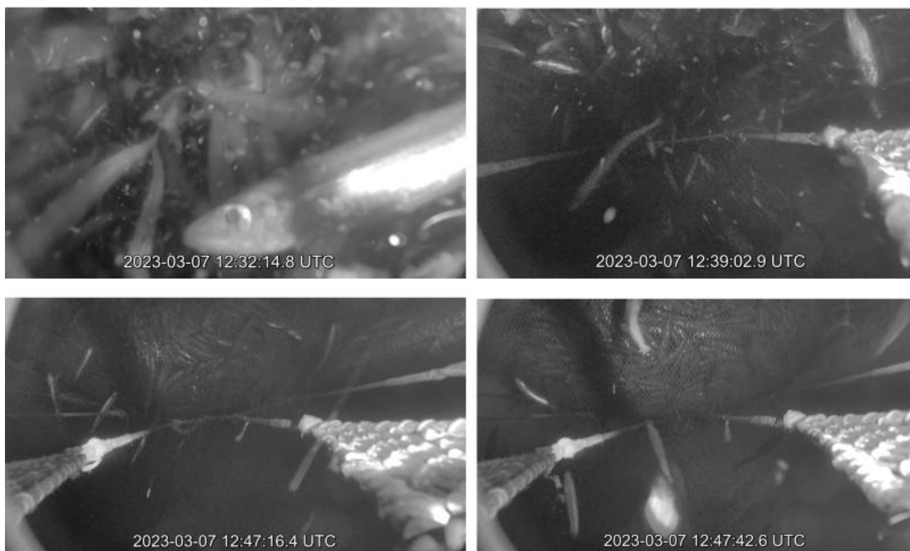
Bilde 16. Ca. 500 tonns hal, sekvenser i kronologisk rekkefølge; (1) fisk går ut etter at sekken er full, (2) Innhiving, (3) Fiskelås sperrer fisken inne i sekken, (4) Fiskelås kommer frem, antakeligvis i forbindelse med utvidet svømmeblære og sekkens ekspansjon.
