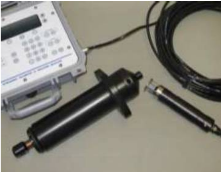
Figur 5.2 Dekksenhet koblet til ledning og hydrofon og Ar-2 (utløser) som ble bygd inn i undervannsbøyen.
