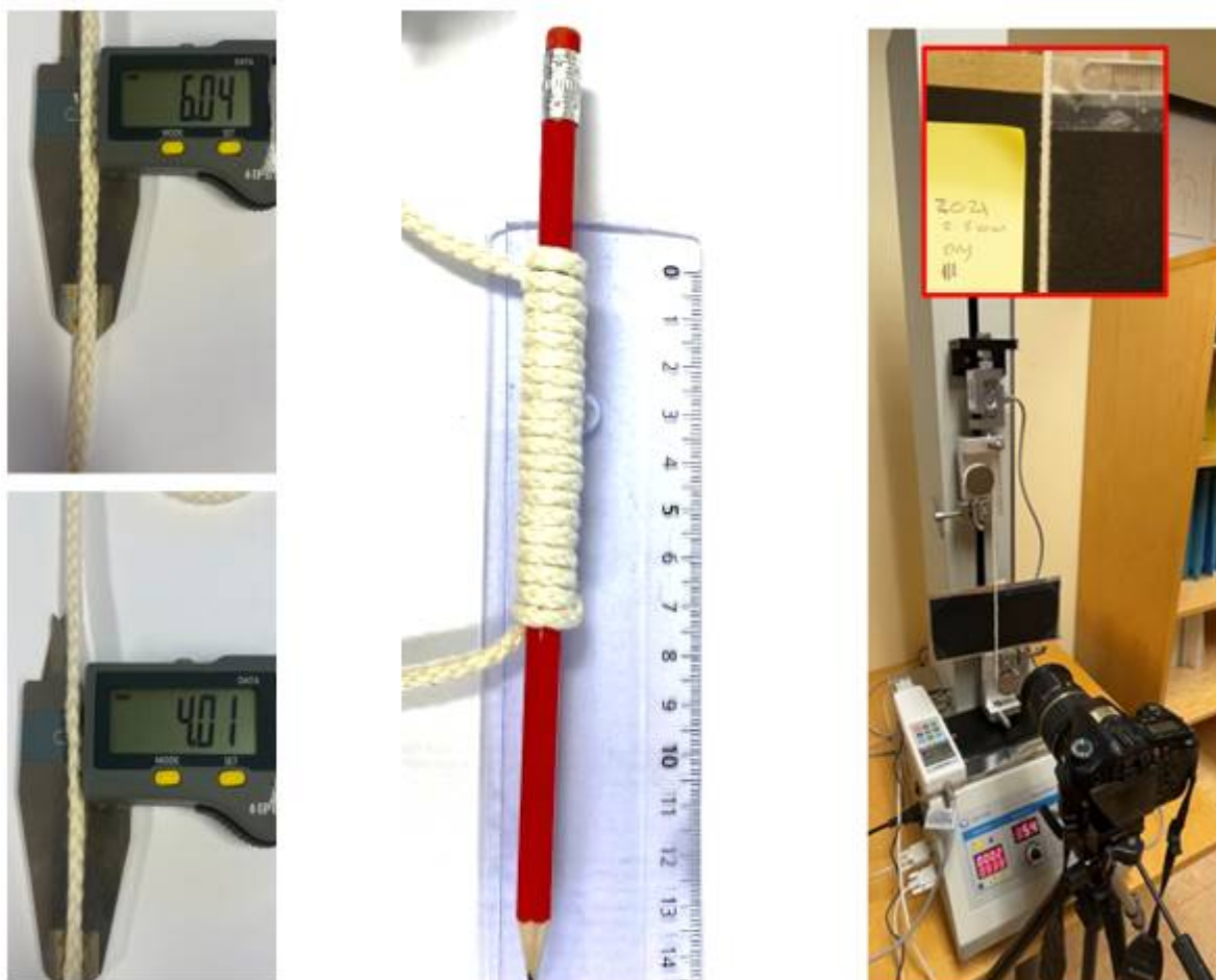
Figur 4.2 . Ulike metoder for måling av tråddykkelse (diameter). Skyvelæremetoden er enkel, men har åpenbart en del usikkerhet knyttet til hvor stramt tråden er strukket og hvor hardt den er presset mot målegapet på skyvelæret. Med skyvelære er det også viktig å måle fra ulike sider om tråden ikke er rund. Eksempelet viser måling av tråd nr. 6 (5 mm), en tråd med tilnærmet rektangulært tverrsnitt. Blyantmetoden med 20 surringer er også en enkel metode, men som for skyvelære vil det uten ytterligere standardisering være variasjon i hvor stramt tråden strekkes under surringen og hvor tett omgangene legges på blyanten. Optisk måling under standardisert strekk anses som den mest objektive metoden, men også den mest tid- og utstyrskreven.
