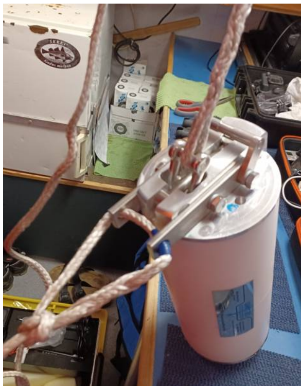
Figur 20. Uwitec utløseren etter modifisering. Til venstre ser vi hvordan gropen for utløssersjakkell har vært forstørret slik at den kan trekkes sideveis. Til høyre ser vi improviserte «festeører», hvor taustropper er tapet på med lerretstape.
