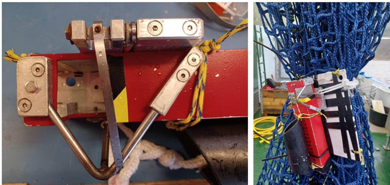
Figur 16. Utløseren etter første hal på tokt 4 i 2022. Til venstre ser vi den skjeve utløserarmen. På bildet til høyre er utløseren montert på en plastplate for å få et bedre moment på utløserarmen fra tauet (tråden) som knyttes rundt sekken.
