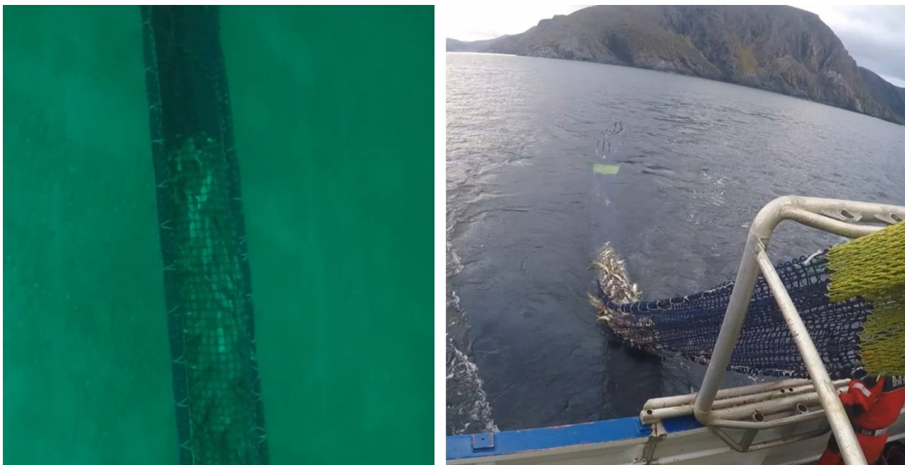
Figur 9. Torsk samlet seg foran den svarte tunnelen (bilde til venstre). Fisken kilte seg fast i kvadratmaskeseksjonene, proppen løsnet ikke av seg selv og fisken måtte ristes ned ved ombordtaking av trål.
