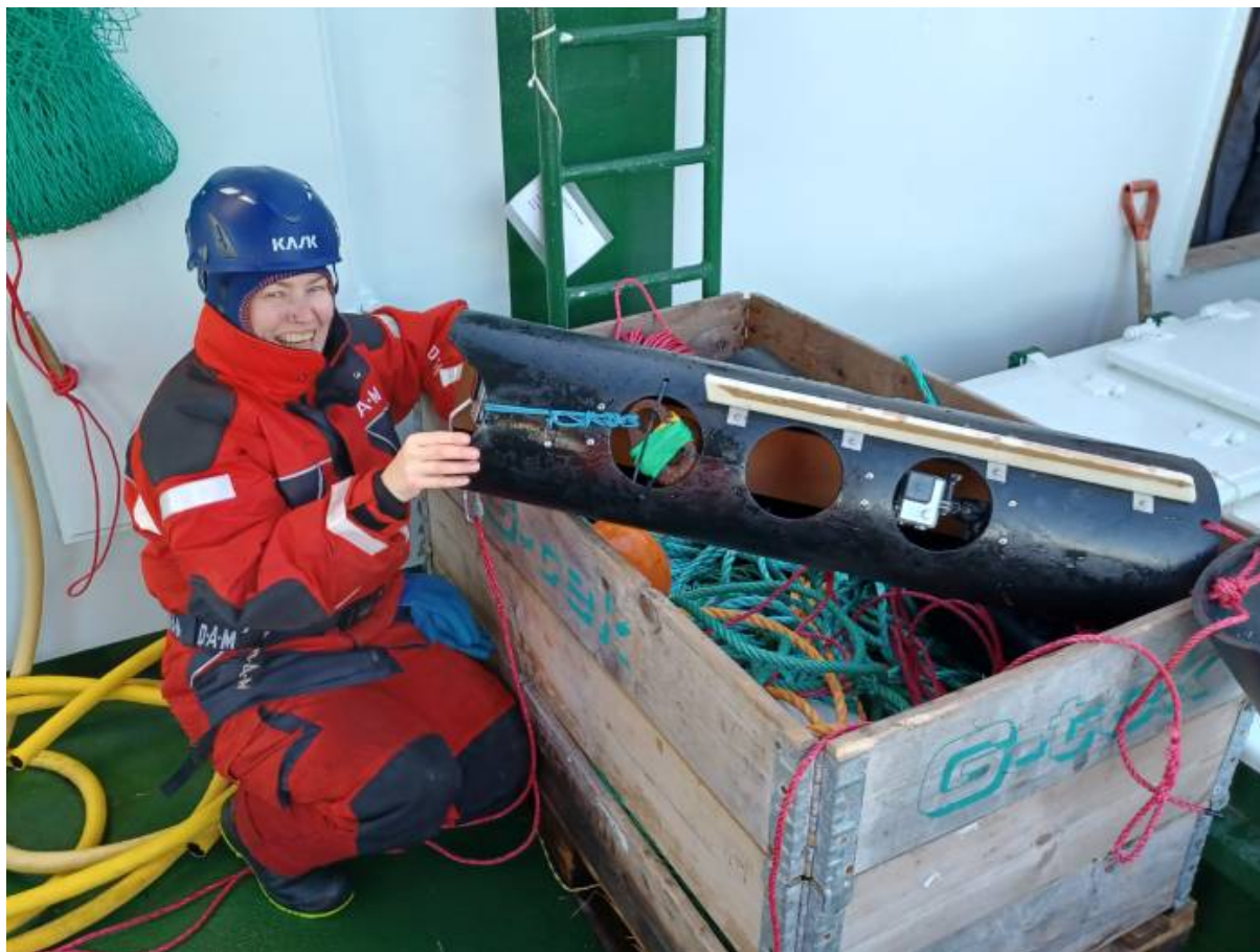
Figur 3. Liz monterer kamera bakst på flygeren. Midt på bildet ser vi et improvisert lodd (G-krok) for å stabilisere flygeren. Gjennom hullene ser vi Divinicell planke langs rørets overkant som sørger for oppdrift. Lengst til høyre ser vi en kite som er knytt til selve flygerøret med rødt tau.
