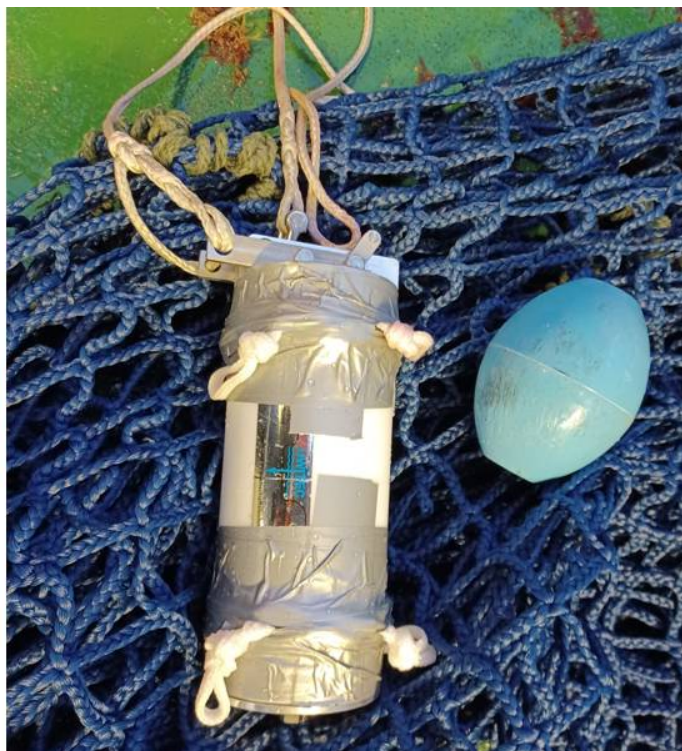
Figur 20. Uwitec utløseren etter modifisering. Til venstre ser vi hvordan gropen for utløzersjakkell har vært forstørret slik at den kan trekkes sideveis. Til høyre ser vi improviserte «festeører», hvor taustropper er tapet på med lerretstape.
