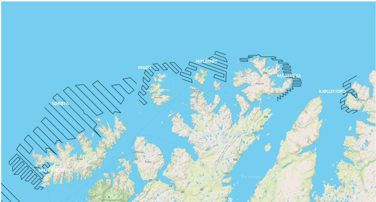
Figur 2 To kart som viser de akustiske kursene. Kursene består av parallelle transekter og kurser imellom disse. Det er resultatene fra disse «parallelle strekene» benyttes i beregningene.
