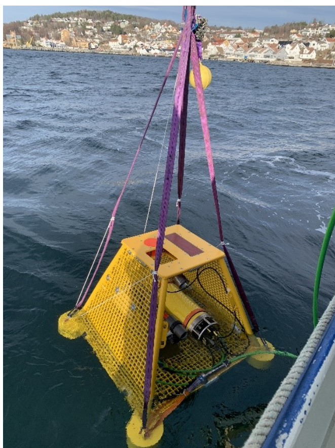
Figur 16 . Utplassering av bunnstasjonen i Drøbaksundet mars 2023.
