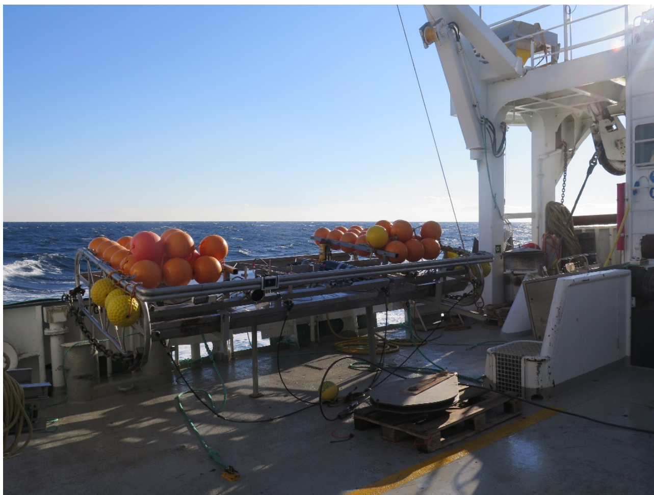
Figur 2. Videorigg med kamera, lys og lasere på vugge, styrbord side.
