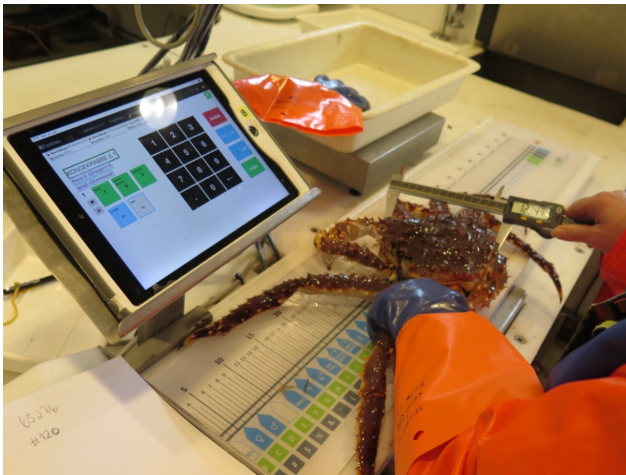
Figur 7. Registrering av data ved hjelp av trådløst skyvelær og iPad (Fish2Data).
