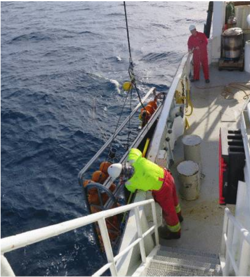
Figur 2. Utsetting av videorigg på styrbord side.
