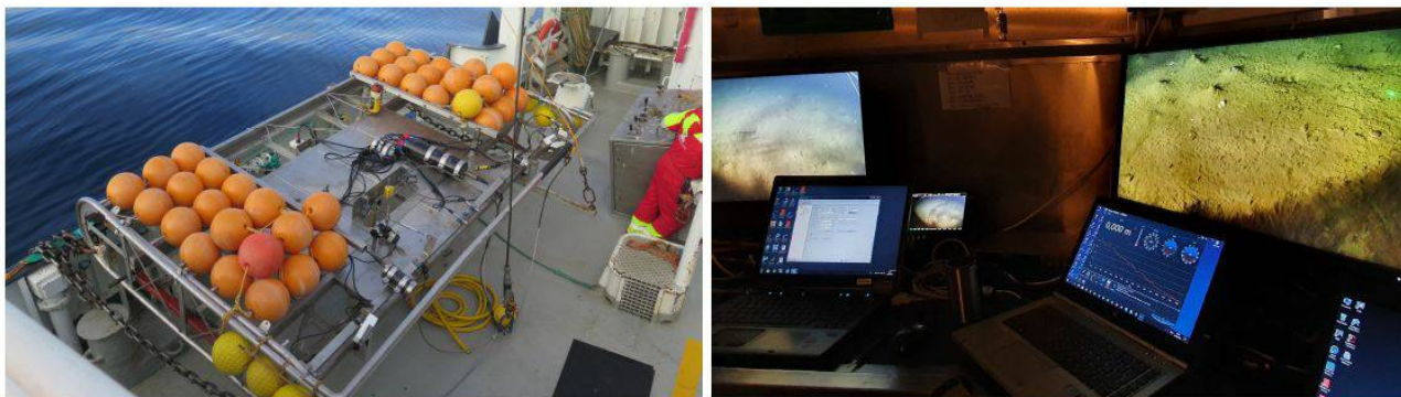
Figur 3.2: Videoutstyr brukt på snøkrabbetokt 2023. Venstre: videoslede, høyre: video-labb.
