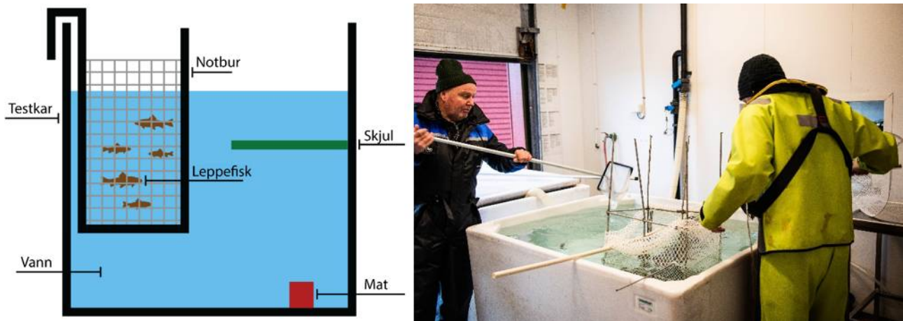
Figur 2. Oppsettet ved trenging av fisk. Skjematisk tegning (venstre bilde) og faktisk oppsett (høyre bilde).
