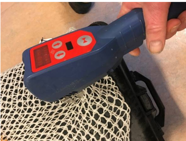
Figur 3. Venstre bilde: Måling av notlinet i en av forsøksposene med en Omega maskemåler. Høyre bilde: Kalibreringsplata for Omega-måleren.
