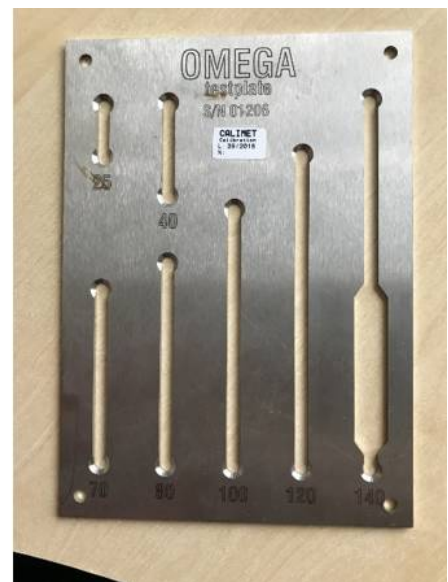
Figur 3. Venstre bilde: Måling av notlinet i en av forsøksposene med en Omega maskemåler. Høyre bilde: Kalibreringsplata for Omega-måleren.
