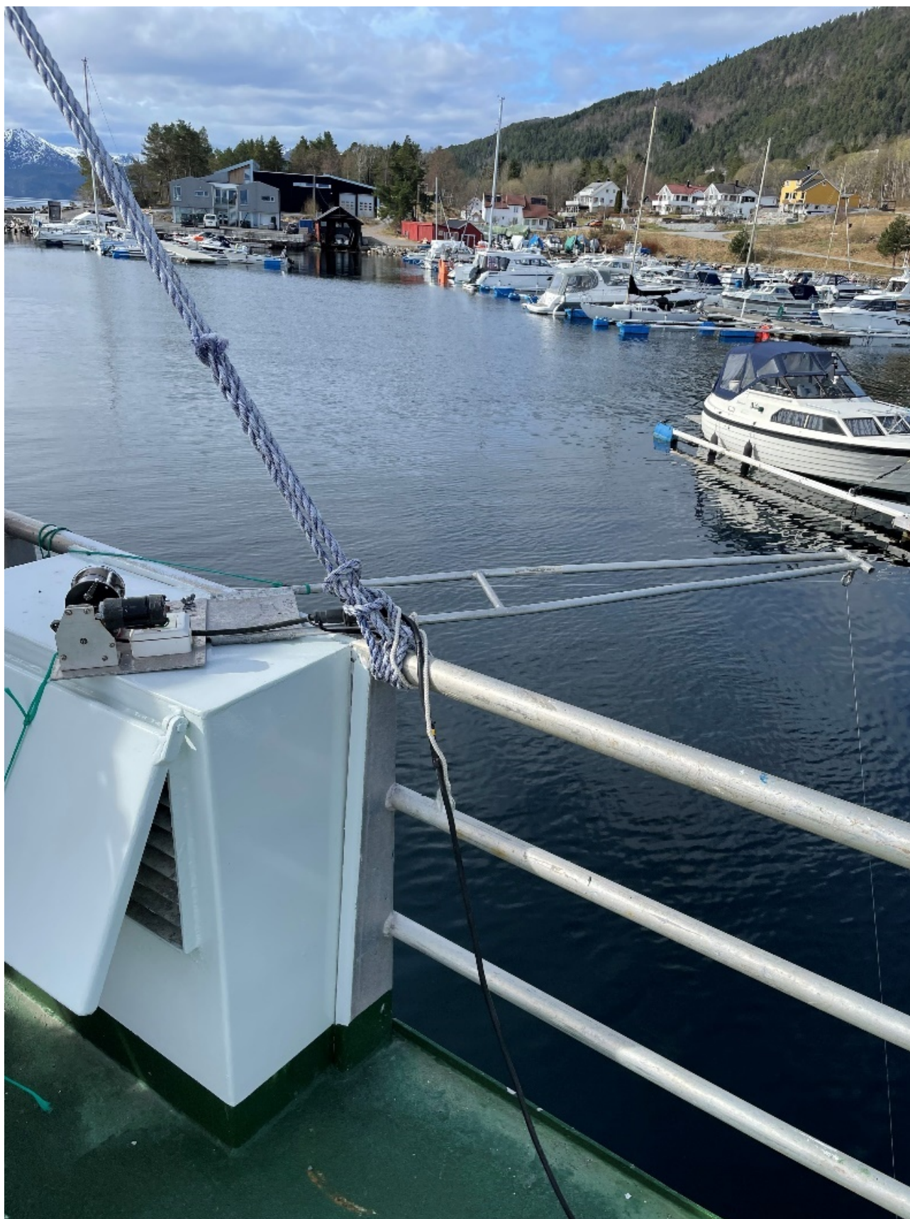
Figur 18. Tre kalibreringsvinsjer ble benyttet for å posisjonere kalibreringskuler ca 11 meter under svingere/kjøl i Tøndergård havn i Molde.
