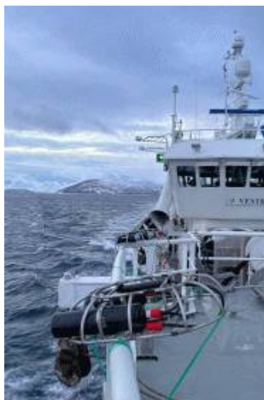
Figur 4. To Dark Vision kamerasystem montert i rekkverket på Vestbris.
