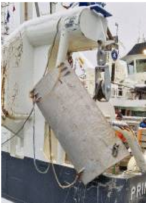
Figur 7. Aluminiumsdørerne som benyttes ved bruk av smolttrålen.
