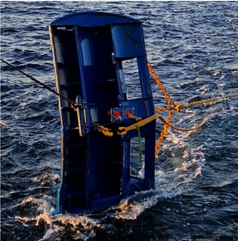
Figur 2. Thyborøn type 26 tråldør med åpne luker.
