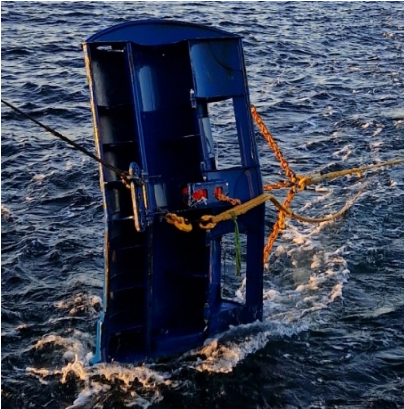
Figur 2. Thyborøn type 26 tråldør med åpne luker.
