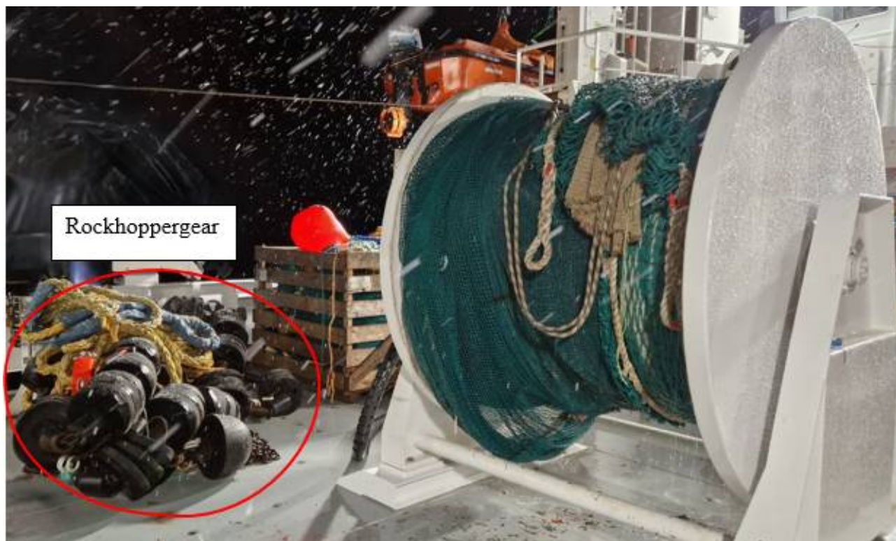
Figur 14. Campelen 1800-trålen uten rockhoppergearet er tatt på trommelen på F/F PIA. Rockhoppergearet ligger på dekket til venstre i bildet.
